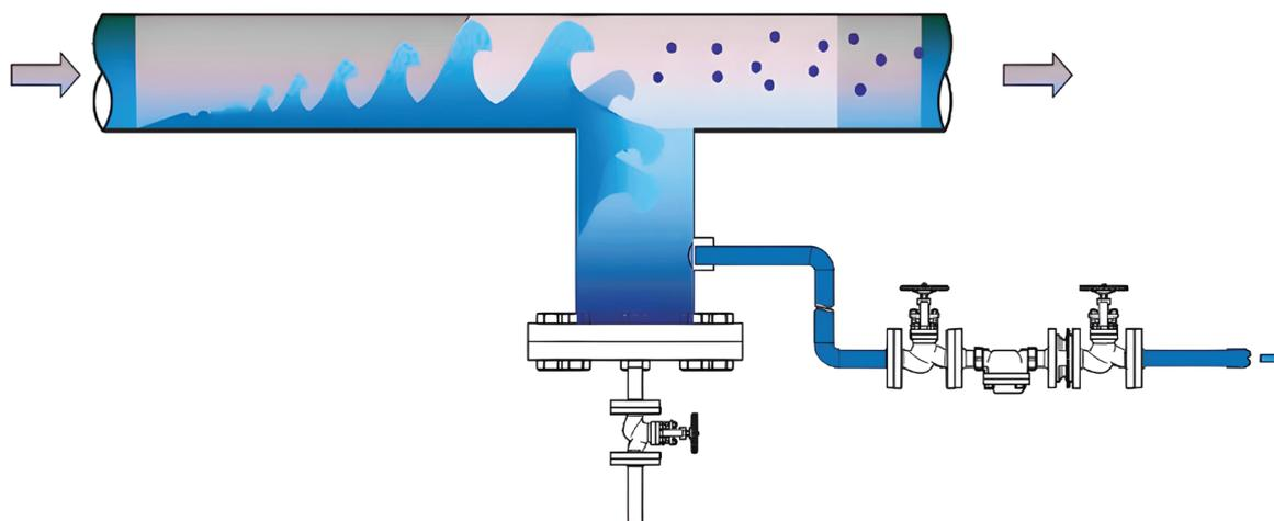
В случае недостаточного диаметра и высоты кармана значительная часть конденсата не будет отведена. Кроме того, в слишком зауженных карманах может наблюдаться т.н. «эффект флейты», когда высокоскоростным потоком пара конденсат вытягивается из кармана обратно в паропровод. Существуют установленные нормы и правила при организации отводящих конденсат карманов.
